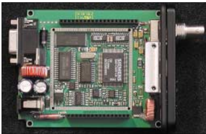
Bild 1: Blick auf die CPU-Platine nach Entfernen des Kühlblechs; links sind Sub-D- und Stromversorgungsbuchse zu erkennen, rechts die Antennenbuchse, und darunter das PA-Modul mit Kühlkörper.
