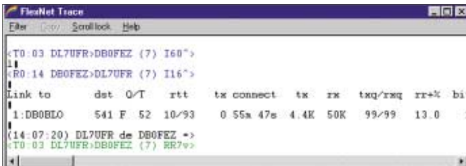
Bild 3: Das Trace-Fenster von PC/FlexNet schreibt den Datenverkehr mit.
