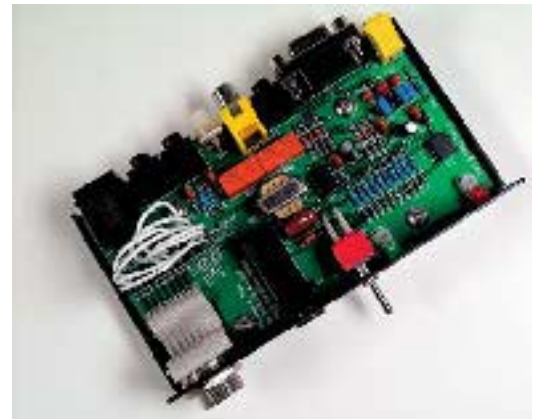
Das Plus aus der Vogelperspektive. Oben rechts drei LED, sie informieren über den Status der RS-232 und helfen beim Setzen der Jumper.
