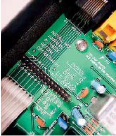
Die Anpassung an die Mikrofonbuchse geschieht über diese Jumper.
